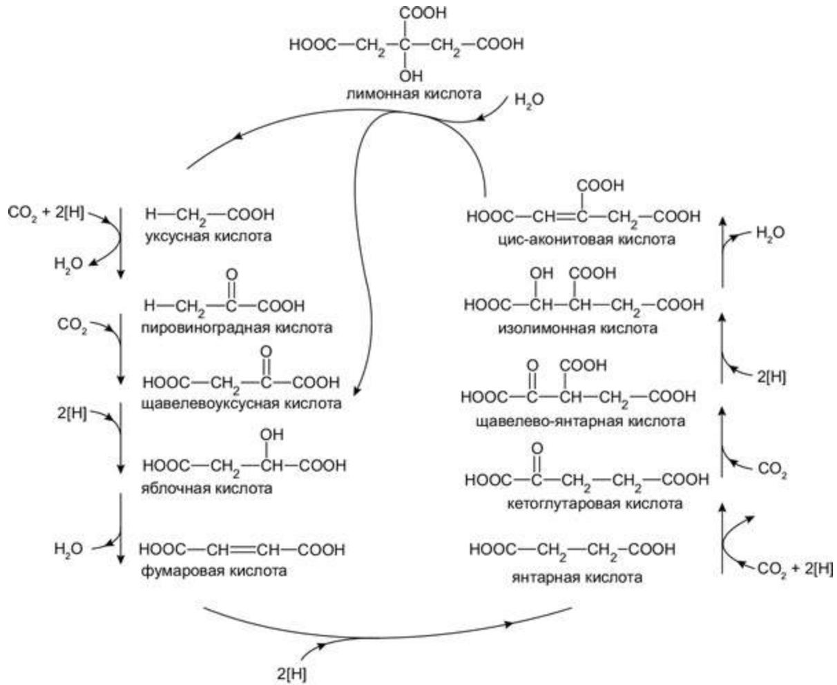
Рис. 11.5. Восстановительный цикл Кребса, в ходе которого одна молекула щавелевоуксусной кислоты образуется из четырех молекул CO<sub>2</sub>
