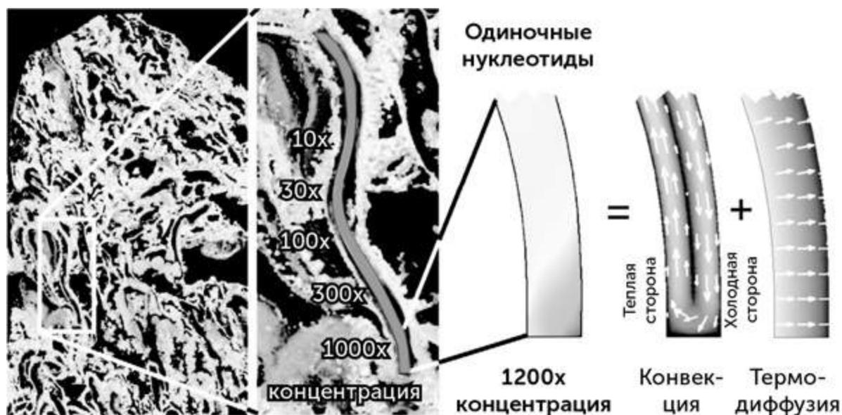
Рис. 9.4. Спил пористых отложений арагонита ( $\text{CaCO}_3$ ) из гидротермальных источников Lost City (слева), прорисовка отдельной поры (в середине) и накопление нуклеотидов и РНК за счет конвекции и термофореза в закрытой снизу поре (справа)
