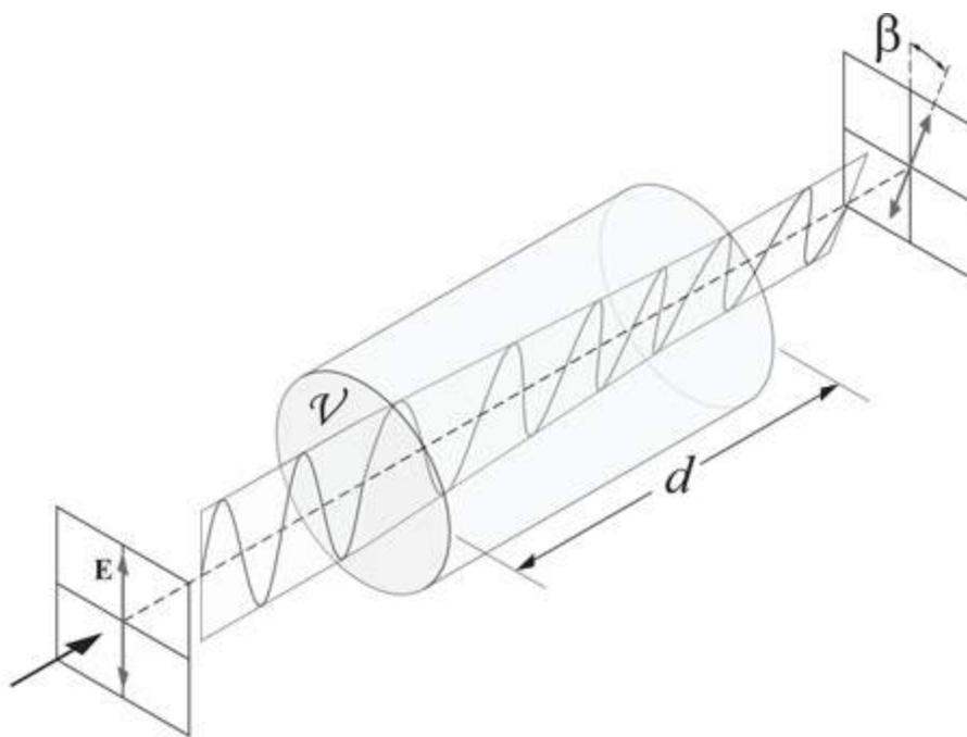
Рис. 8.2. Поворот плоскости поляризации света в растворе оптически активного вещества;  $\beta$  — угол поворота плоскости поляризации
